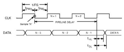
Figure 1. XRD87L75 Timing Diagram
