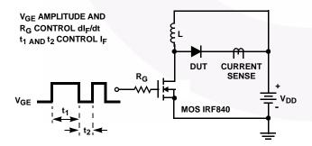
FIGURE 5. t<sub>rr</sub> TEST CIRCUIT
