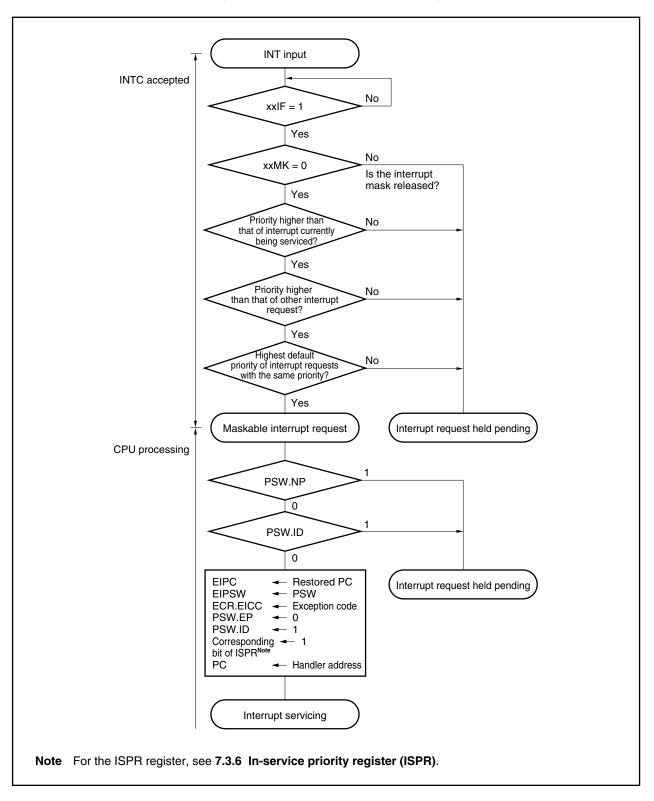
Figure 7-4. Maskable Interrupt Servicing
